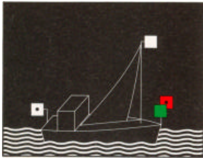
De artikelen 3.08, lid 5, en 3.13, lid 7: Schip dat onder zeil vaart en tegelijkertijd zijn mechanische middelen tot voortbeweging gebruikt.
